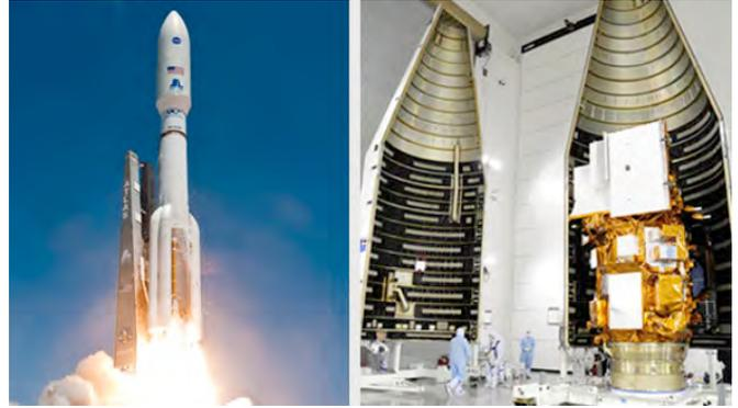
Llançament i encapsulament d'un satèl·lit Landsat. Fotos: NASA
