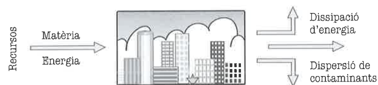
Figura 1.3 La ciutat com a sistema obert a la matèria i a l'energia. Els recursos (matèria i energia) entren: l'energia es transforma i dissipa en calor; els materials, en part, es dispersen com a contaminants gasosos, líquids o sòlids
