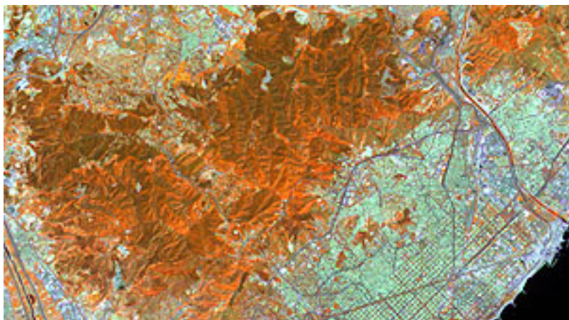
Finestra de MiraMon amb una combinació en fals color 4+5+3 d'imatge de satèl·lit Landsat 7 ETM+ (13/06/02) sobre Collserola. Vermell: vegetació activa. Verd/blau: cobertes urbanes. Blau fosc/negre: masses d'aigua. Font: G. Moré.
